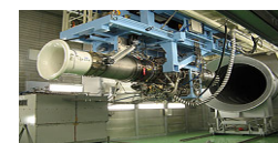
<エンジン実証設備>
