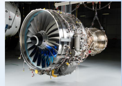
V2500のバイパス比は約5(ファン径は1.6m)、最新のPW1100Gでは12(径は2.06m)
