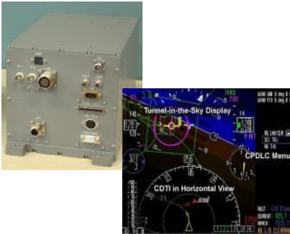
機上搭載装置 (高精度衛星航法装置、統合型表示装置)
