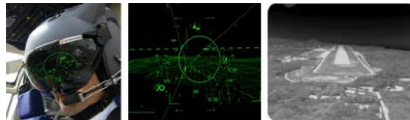
ヘルメットマウントッドディスプレイ(HMD)と赤外線カメラの映像や地図データを表示した例
