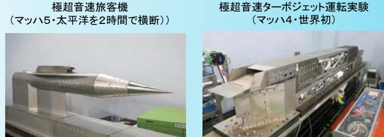
マッハ5クラスの極超音速旅客機の実用化を目指して、離陸からマッハ5まで連続作動できる「極超音速ターボジェット」の研究開発を進めています。これまでに、マッハ4飛行環境でのエンジン運転実験を実施し、推進性能を取得しました。また、大学と連携して極超音速飛行実験(マッハ5)に向けた準備を進めています。
