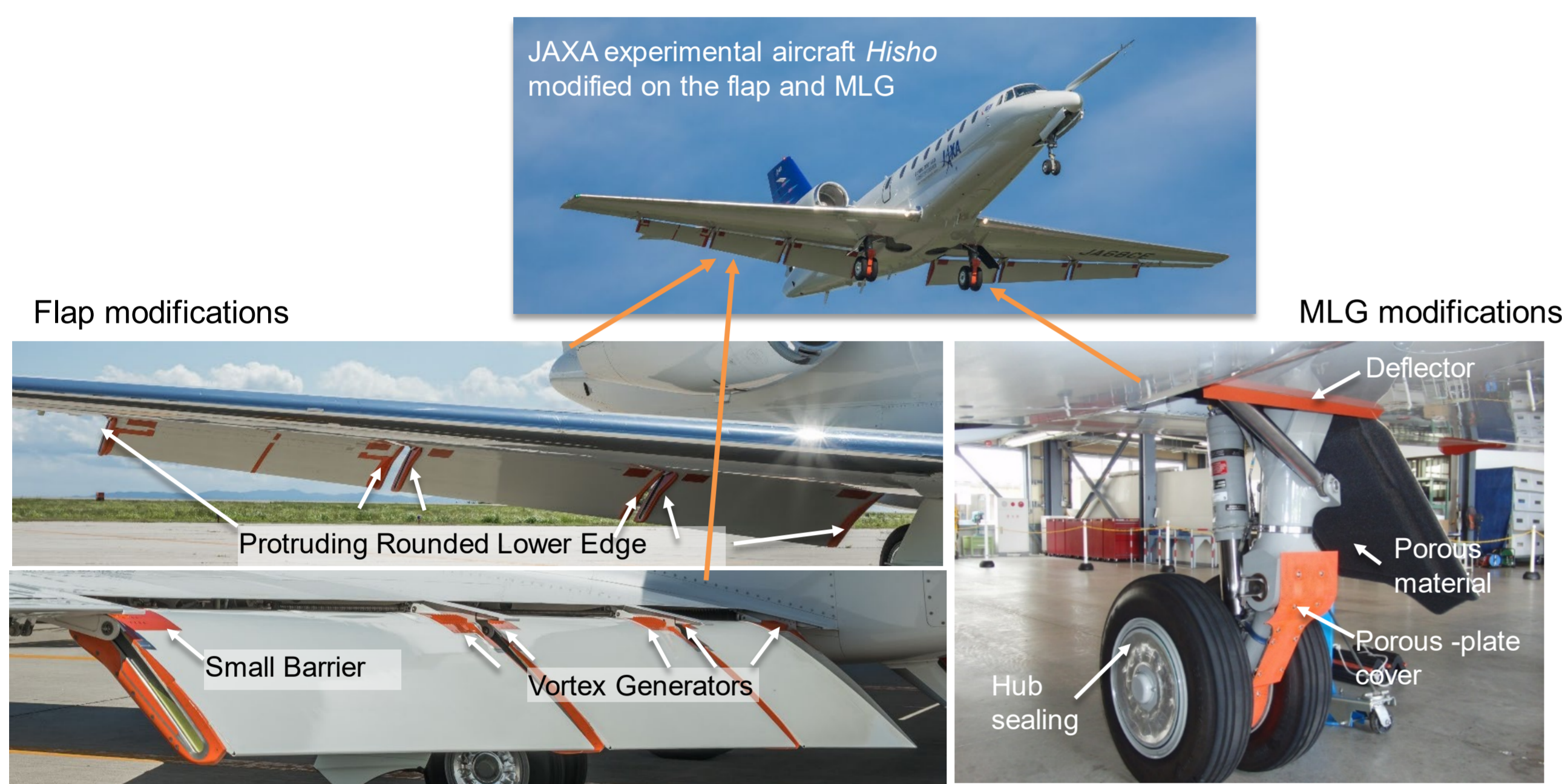
JAXA実験機「飛翔」のフラップと主脚に装着した低騒音化デバイス
