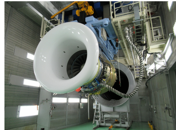
地上エンジン運転試験設備に導入されたF7-10エンジン
