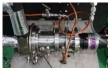
液体水素燃料供給技術 (少流量、高吐出圧、 精密制御)
