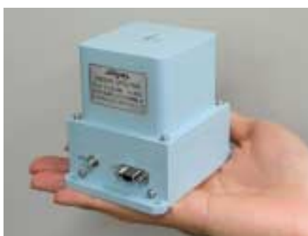
図4 超小型高精度航法装置“Micro-GAIA”の試作品
