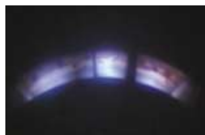
図3 燃焼器後方のカメラによる 火炎観察 (アイドル条件)
