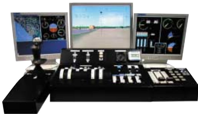
図2 FLOPS操縦装置と表示画面
