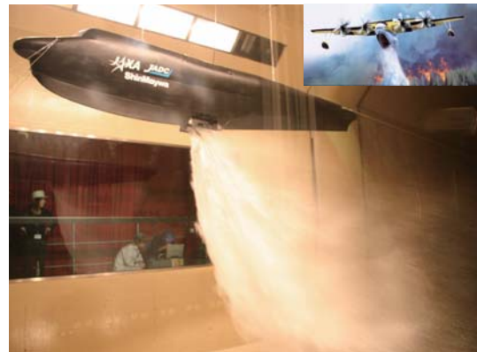
風洞放水試験状況および空中消火想像図 (右上:新明和工業提供)
