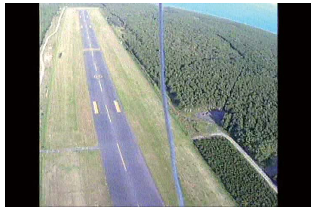
図3 北海道における距離25km受信の画像 パラボラアンテナとアンテナ直下にプリアンプを使用して受信
