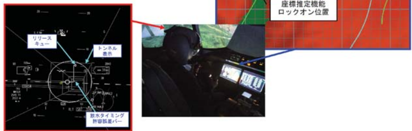
図3 HMDに表示される情報の例 パイロットが被っているのがHMD。顔前面のバイザー部分に支援情報が表示される。トンネル表示に従って飛行を行うことで安全に放水位置に到達できる。目標に近づくにつれリリースキューが徐々に下がり、許容誤差バー内に入った時に放水し、消火する。
