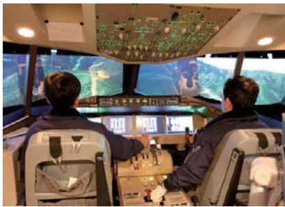
図2 飛行シミュレータ試験の様子 飛行シミュレータに山岳火災を模擬し、放水飛行を評価する。計器表示に火災点及び放水位置の情報を表示するとともに、後述のヘルメット・マウンテッド・ディスプレイ(HMD)も加え、より効果的な操縦支援技術の研究評価を行っている。
