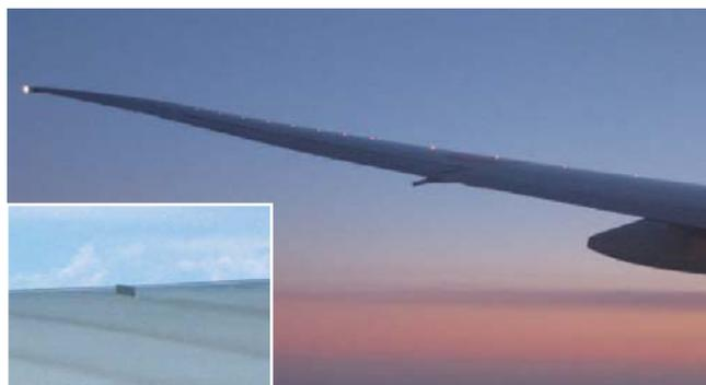
ボーイング777機に取り付けられたボルテックスジェネレータ点灯しているように見えるのがVG。太陽光を受けて光っている。一番左は航空灯。
