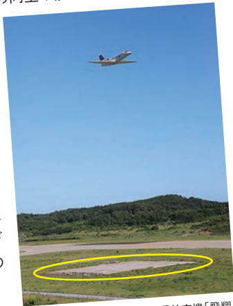
フェーズド・アレイ(丸で囲まれた部分)上空を飛行する実験用航空機「飛翔」
