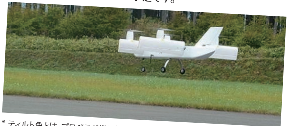
*ティルト角とは、プロペラが機体前方を向いているときを0度、真上を向いているときを90度として測った角度。
