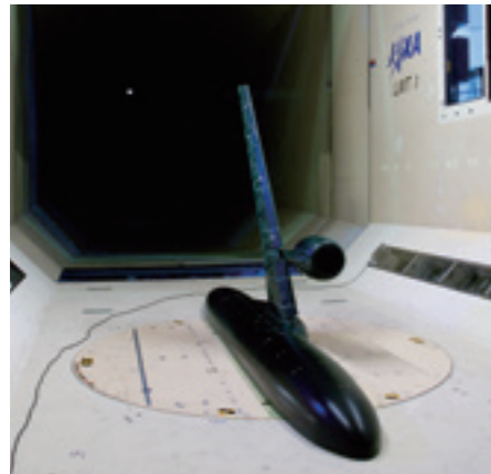
航空機用としては日本最大の測定部を持つ6.5m×5.5m低速風洞。大型の模型による計測が可能
