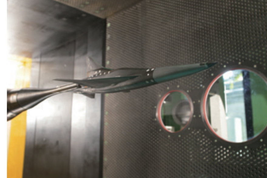
2m×2m遷音速風洞。遷音速（音速前後の速さ）で飛行する航空機の特性を調べるために使われる
