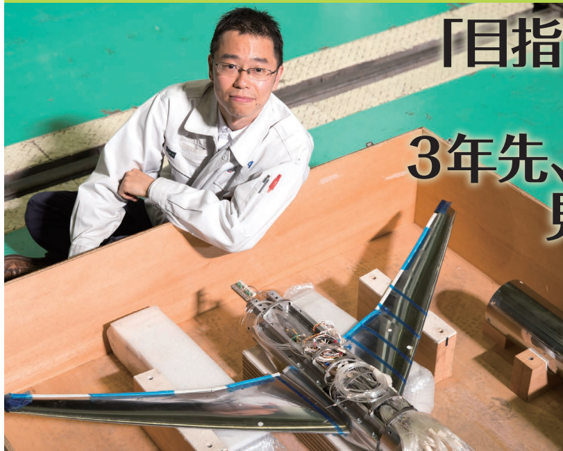
手前の模型は、異なる風洞間でのデータ比較やコンピューターシミュレーションの計算結果の検証に使用される、NASA Common Research Model (CRM) と呼ばれる標準モデルの縮尺模型
