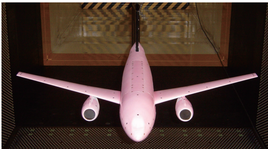
感圧塗料(PSP)は圧力に応じて明るさが変化する発光塗料で、PSPからの発光をCCDカメラなどで計測することで圧力分布を画像として計測。圧力を測りたい模型にPSPを塗布(画像上)することで、面全体で圧力分布を計測できる。赤い色ほど圧力が高い(画像下)
