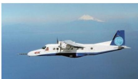
JAXAの実験用航空機「MuPAL-α」には、機械式操縦装置とFBWの二つが搭載されており、スイッチ一つで簡単に切り替えることができるようになっています。MuPAL-αのFBWでは、コンピューターにさまざまな航空機の飛行特性データを組み込むことで、別の航空機の操縦を模擬できる「インフライト・シ
