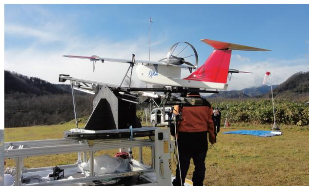
災害現場上空をカメラで撮影することを想定した災害監視無人機システムの飛行実験(左)。トラックの荷台に設置されたカタパルトから離陸する災害監視無人機(上)。
