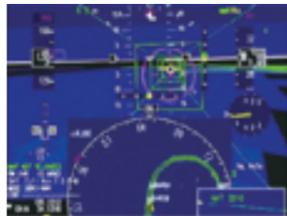
コックピット内に表示されるトンネルインザスカイの画面例。GBASで設定される進入経路が画面に表示される。
