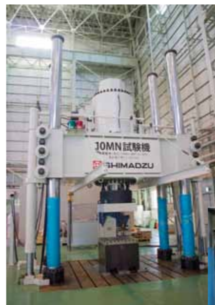
航空機開発メーカーからも引き合いがある10MN試験機。1,000tまでの負荷をかけることができる。
