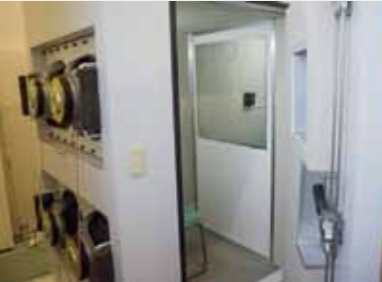
ドアを開けた状態。左に見えるスピーカーが、背面側の低周波用スピーカー。
