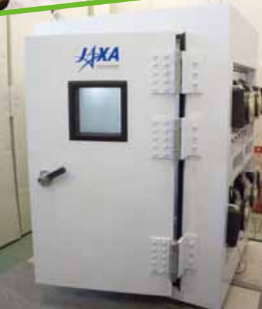
ソニックブームシミュレータの外観。壁の厚みは10cmあり、防音対策も取られている。
