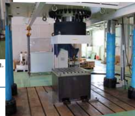
肉厚の複合材料構造の非破壊評価を行うことができるX線CT探傷装置。小惑星探査機「はやぶさ」のカプセルを試験したことも。
