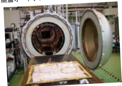
実験用プリプレグを真空状態にするバックに入れ、熱センサを配置して複数点の温度を測定しながら硬化させる
