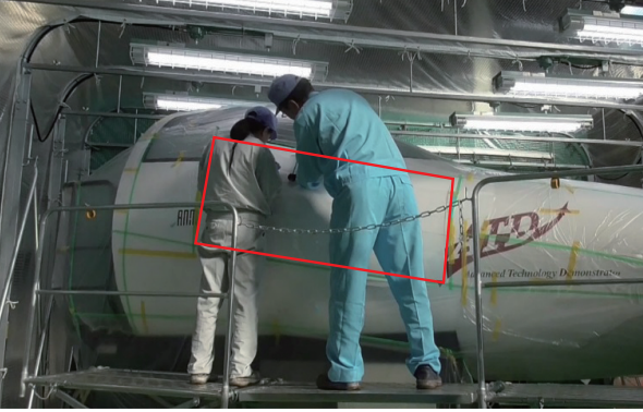
実物大航空機模型への 塗装型リプレットの施工状況 (首都大学東京との共同研究； 赤い四角の部分が塗装範囲)
