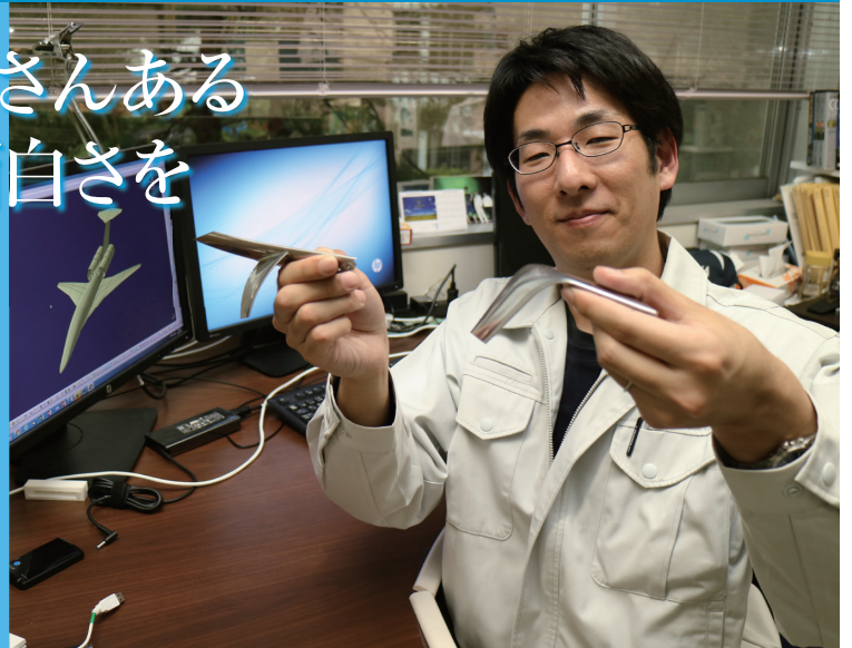
共同研究で製作した主翼の風洞模型。下向きのウィングレットや新しい発想による主翼形状を検討した
