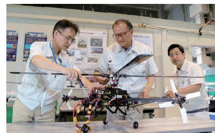
外装を取り外した状態の試験機のラジコンヘリコプター
