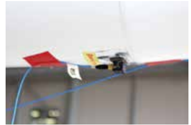
機体のあちこちに配置された加速度センサーによって、機体の振動を計測する。
