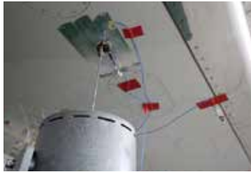
主翼下面に配置された加振機。0～70Hzの振動をランダムに発生させる。
