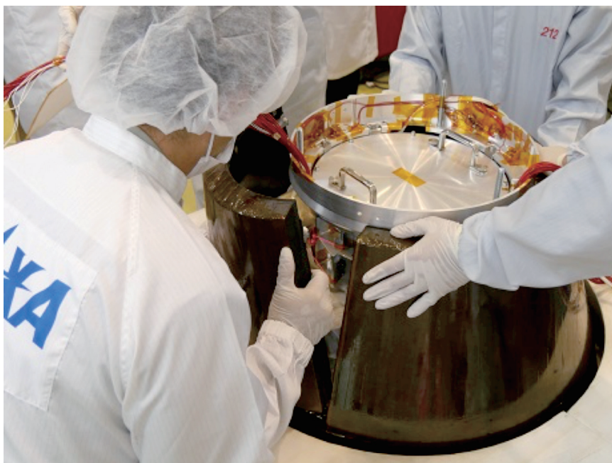
小型回収カプセル 現在開発中の小型回収カプセルの直径は84cm。「このとりのり」やISSのハッチを通ることができる。
