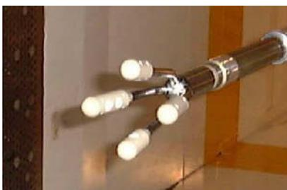
写真2 遷音速風洞で試験中の超音波風速計
