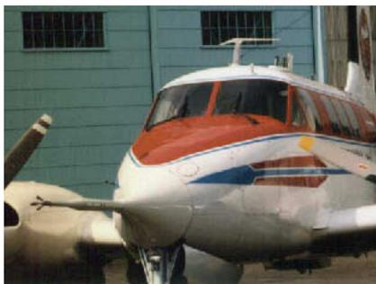
写真1 ノーズブームに超音波風速計を搭載した実験用航空機(B-65)
