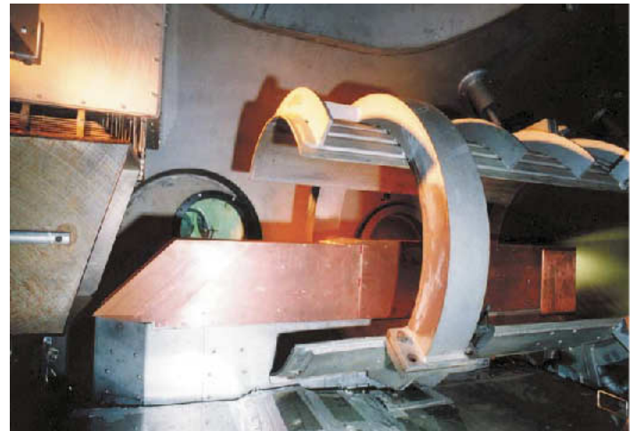
写真2 マッハ数8飛行条件下での燃焼試験の様子
