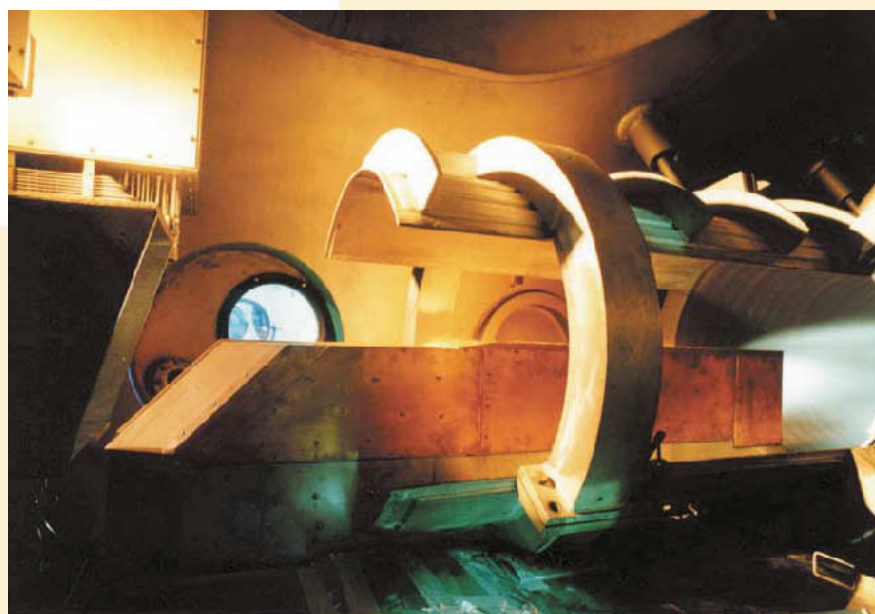
写真: スクラムジェットエンジン燃焼試験 (p.2)
