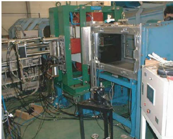
写真 1. 60cm磁力支持天秤装置
