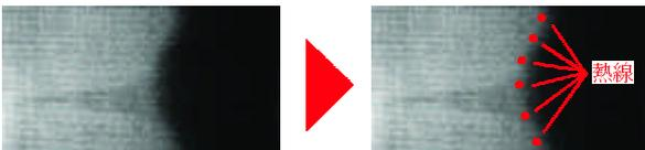
ナフタレンを模型表面上に噴霧し気流に当たると、乱流部分では速く昇華するために模型表面の黒色が現れ、層流部分ではナフタレンが白く残ります。
