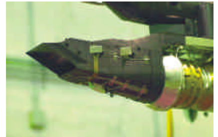
写真1 ジェット実験機第1次設計形状インテーク模型
