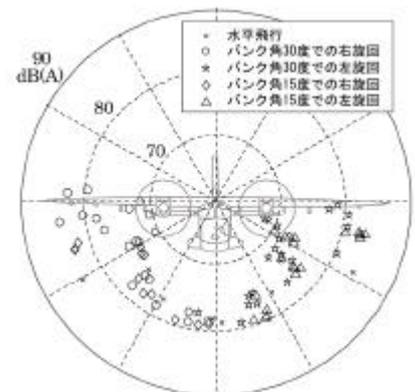
図3 騒音計測結果の例
