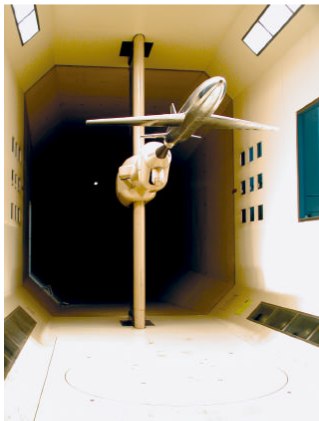
写真 当研究所所有の6.5m x 5.5m低速風洞での試験風景
