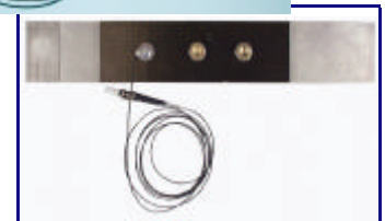
(上)スマート・ボルト (下)試験片につないだ様子
