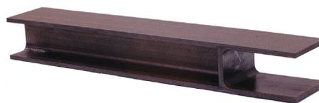
図3 翼と耳金部を一体成形した3次元織物複合材料
