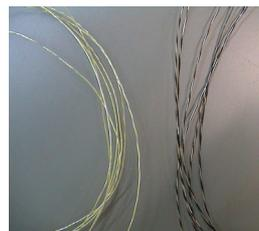
図2 放電実験用のベアテザーサンプル
