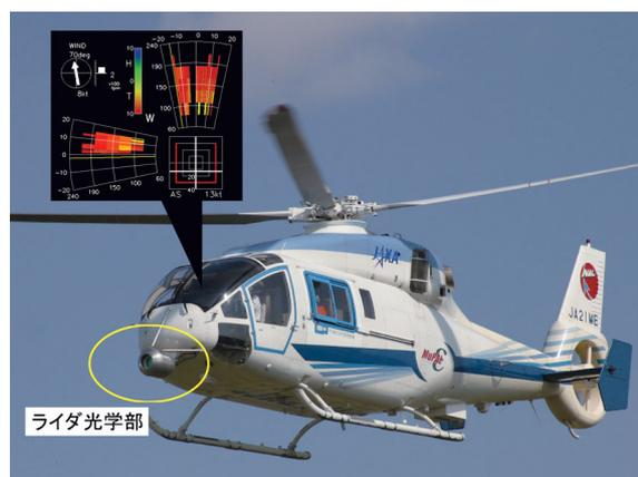
図 実験用ヘリコプタへの風計測用ライダの搭載とパイロットへの表示の例
