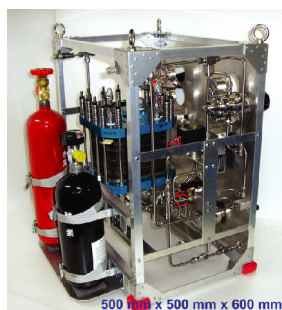
図3 100W級小型軽量型燃料電池発電システム試作品
