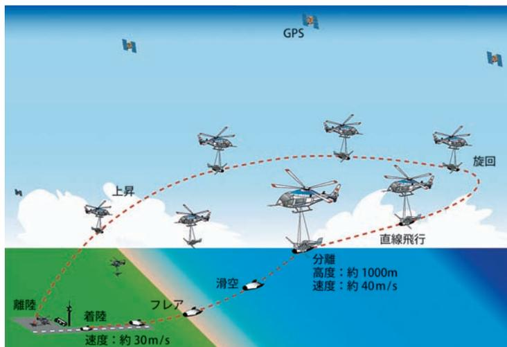
機体にはエンジンがないため、ヘリコプタで懸架して上空まで運びます。所定の位置と速度で分離された機体は、滑空しながら自動操縦で滑走路へ近づき、着陸を試みます。
