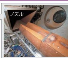
ノズルを介することで、気流の持つ熱エネルギーは速度に変換されます。
