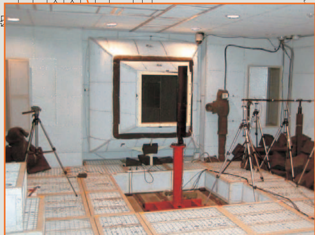
図2 高揚力装置騒音低減試験の様子（三菱重工業株式会社提供）
