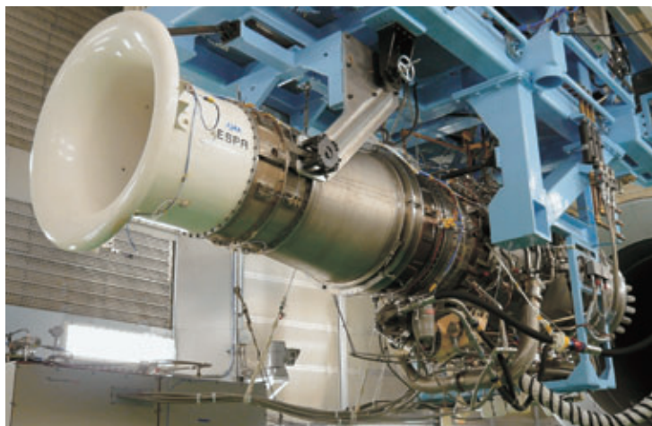
図3 ターボファンエンジン試験設備に設置されたESPRエンジン
