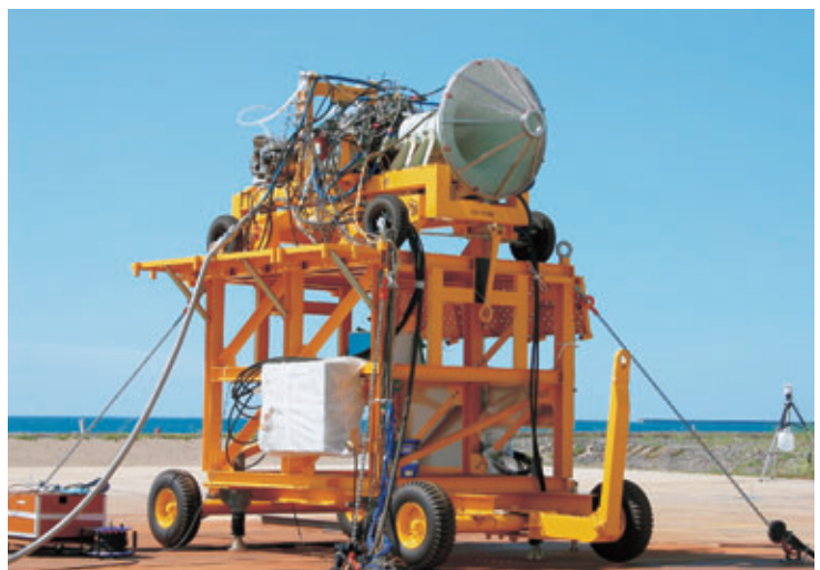
図2 YJ-69エンジンを使った能代多目的実験場での騒音計測試験の様子（2007年度）
