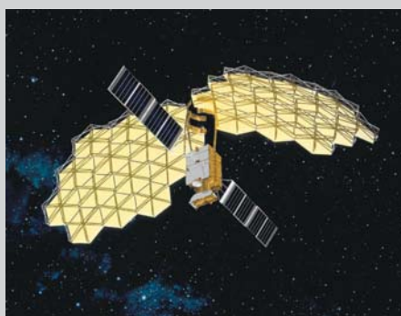
ふたつの大型展開アンテナとふたつの太陽電池パドルを持つ、端から端までが40mの大きさの衛星です (重量: 約3トン)。大型展開アンテナ1枚の面積は19m×17mで、これはテニスコート1面分ほどです。静止衛星としては世界最大級のサイズとなります。
