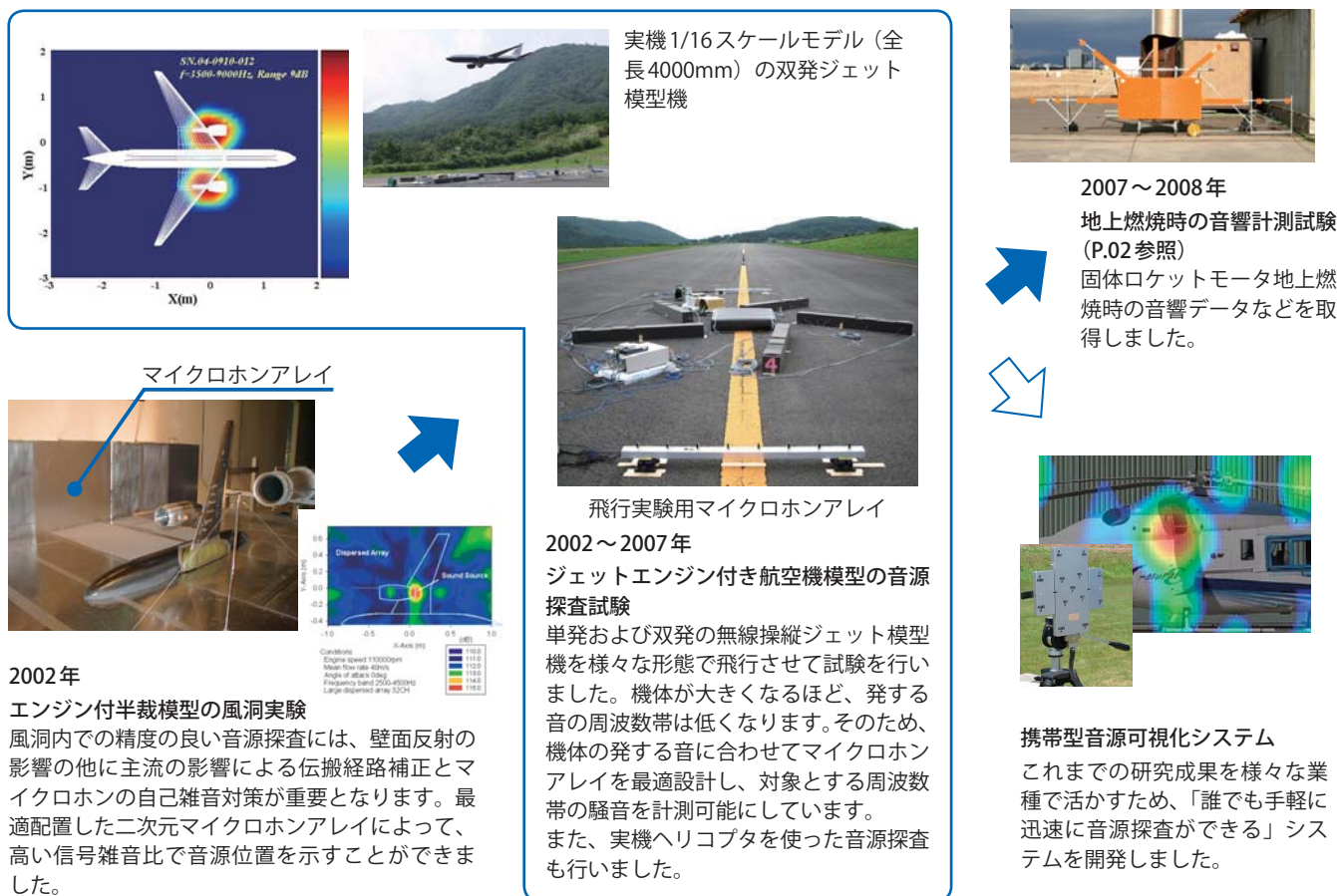
図2 マイクロホンアレイを使った騒音低減のための音源探査試験
