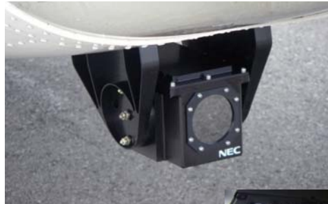
図4 機体下部に搭載されたFLIR
