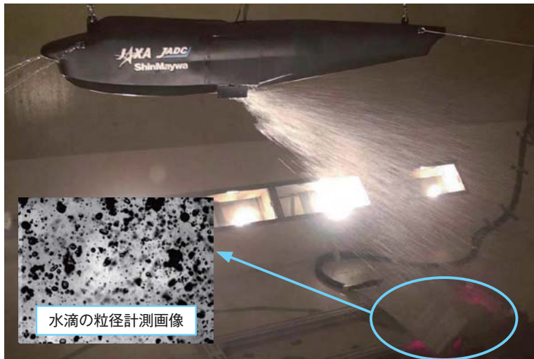
図 放水試験の様子
