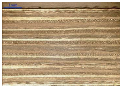
図2 ポリイミド基CFRP（左）と断面の顕微鏡写真（右）
