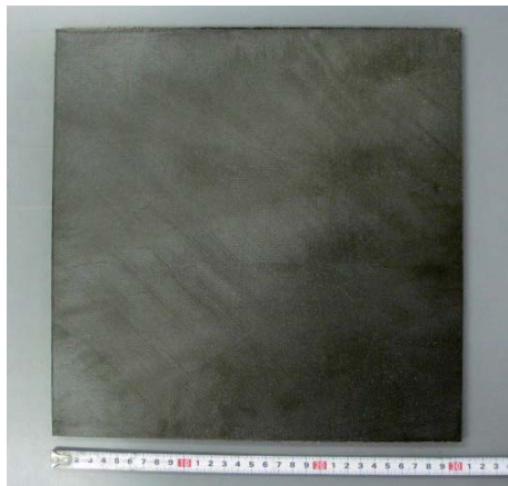
図2 ポリイミド基CFRP（左）と断面の顕微鏡写真（右）
