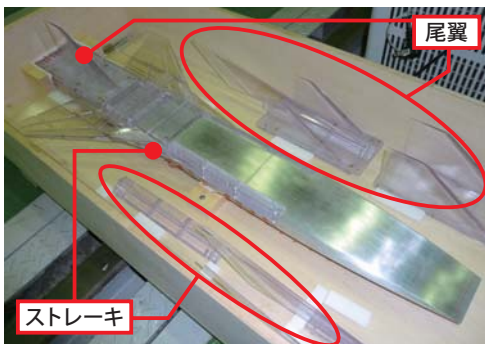
図1 JAXA 2m×2m低速風洞における極超音速旅客機の低速性能確認試験
