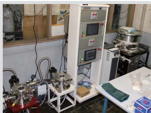
真空ボールオンディスク摩擦試験機・ 真空軸受試験機
