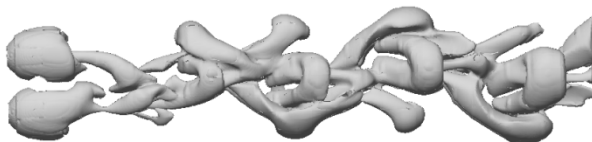
図4. Re = 300 での二球の渦構造 (球中心間距離 1.5D )
