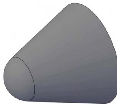
図1 無着陸サンプルリターンに向けて提案された高弾道係数を有する機体形状 [2]
