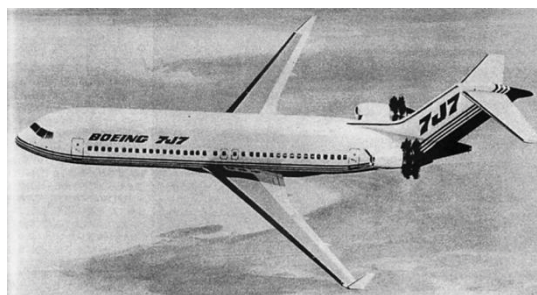
図3 燃費低減のためにUDFエンジンを装着し、炭素繊維複合材料の使用も計画された7J7（航空情報、1987年7月号）
