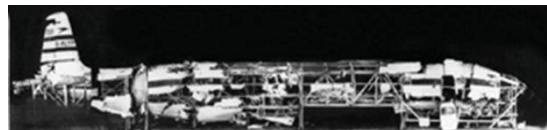
図6 地中海から回収されたコメット機の破片 (英国科学博物館)
