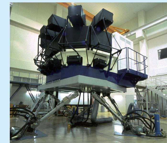
6自由度油圧モーションシステム、プロジェクタ型のビジュアルシステムなどを装備する、飛行機用のシミュレータです。
