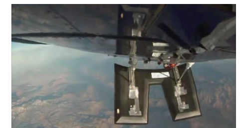
脱オートクレーブ成形法で作製した複合材スピードブレーキの飛行実証試験。従来のアルミ合金製と同等の強度・機能で約40%の軽量化を実現
