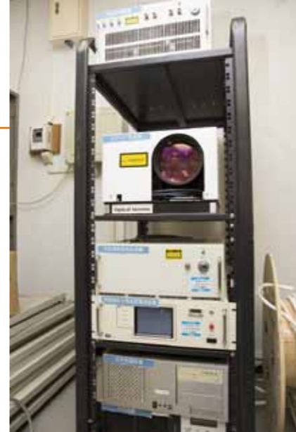
約9km先の乱気流を検知できることを実証したモデル。150kgの重量をいかに軽減するかが航空機搭載の課題となる。
