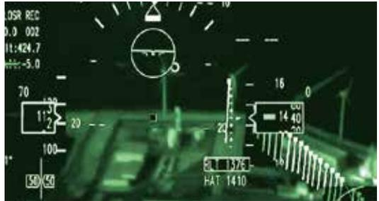
レーザー距離計が計測した距離から地表物の高さを表示するSAVERHの表示画面
