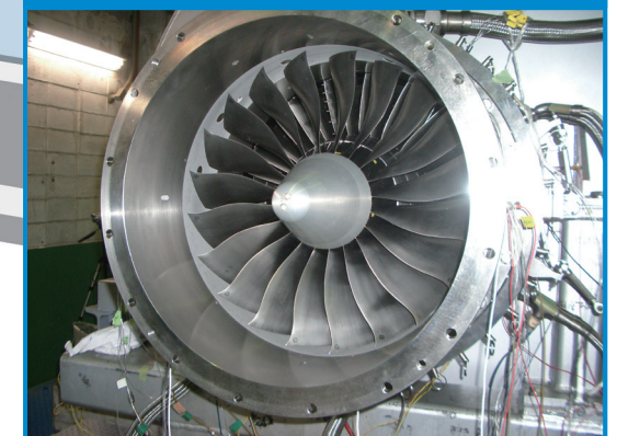
aFJR ファン供試体*搭載状態 With aFJR fan mounted on the test rig.
