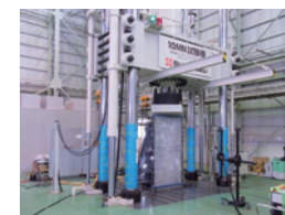
炭素繊維強化プラスチック (CFRP) パネルの圧縮試験
