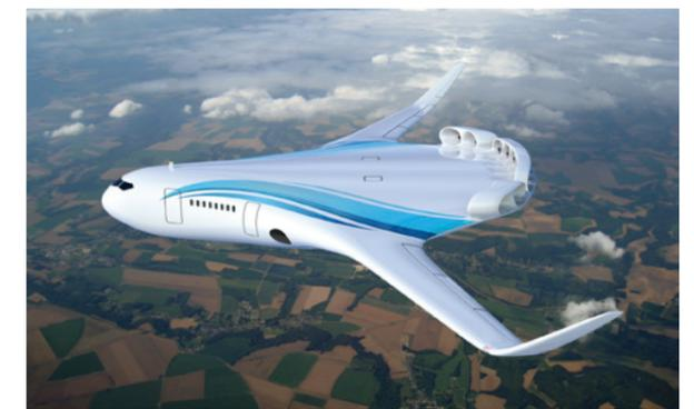
低ソニックブーム設計を適用した小型超音速旅客機 (イメージ図)
