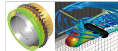
エンジン圧縮機翼列解析およびヘリコプタ胴体/ロータ干渉解析
