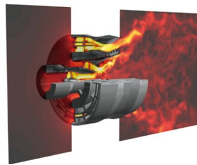
エンジン燃焼解析ソフトウェア「HINOCA」による航空エンジン燃料ノズルの解析結果のマッハ数分布
